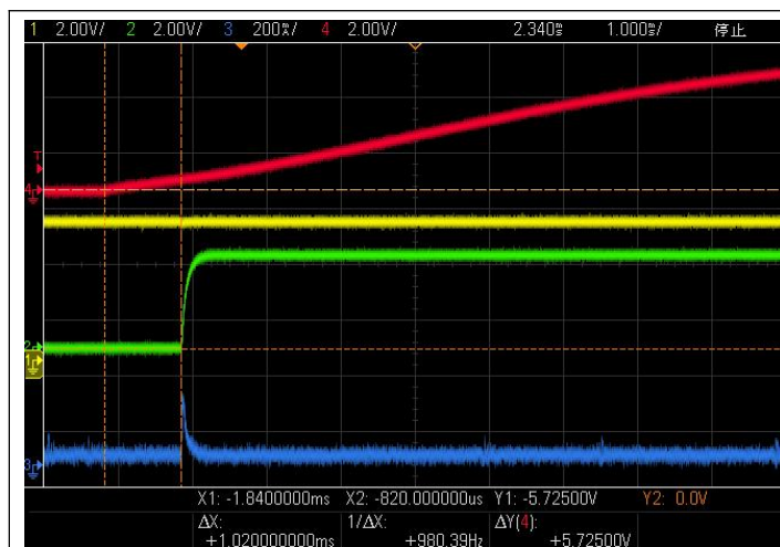
Fig 5. EN Power ON( I_{OUT}=0mA )
